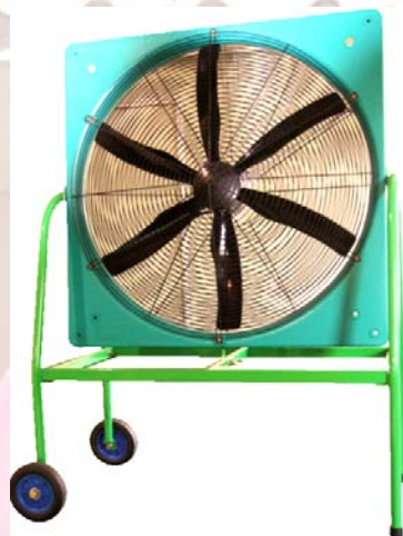
品名: PGF-1000R 配置: 0.66 KW 轉速表: 26280 RPM 風量: 3500 CMH
